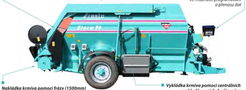
Nakládka krmiva pomocí frézy (1500mm) vybavené reverzním chodem zaručující rychlé nabídní produktů
