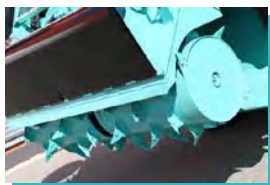
Nakládka krmiva pomocí frézy (1500mm) vybavené reverzním chodem zaručující rychlé nabídní produktů
