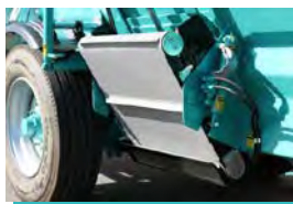
Vykládka krmiva pomocí centrálních vyskladňovacích dveří a pásů dodávaného v několika délkách - dle potřeb zákazníka
